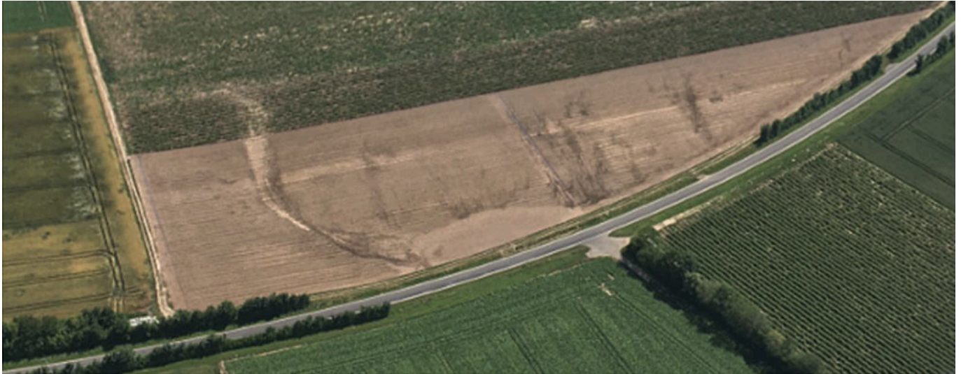
Aufnahme von Julian Krause am 3.7.2021: Erosion und Verschlammung nach Starkregen im Ochsenfurter Gau bei Allersheim. Im Bild sind die oberflächlichen Abflussbahnen deutlich zu erkennen. Die Niederschläge sammelten sich oberhalb der Straße in einem Tümpel (helle, runde Struktur).
